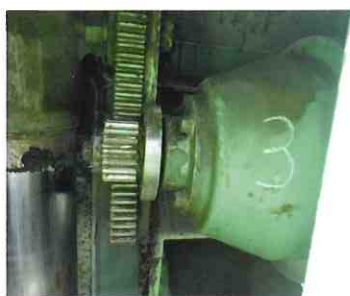
洪水吐ゲートのギア歯当りの変形
