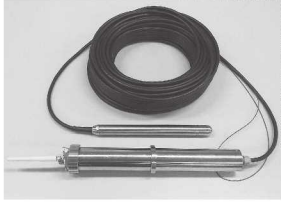
▲設置される水位計
