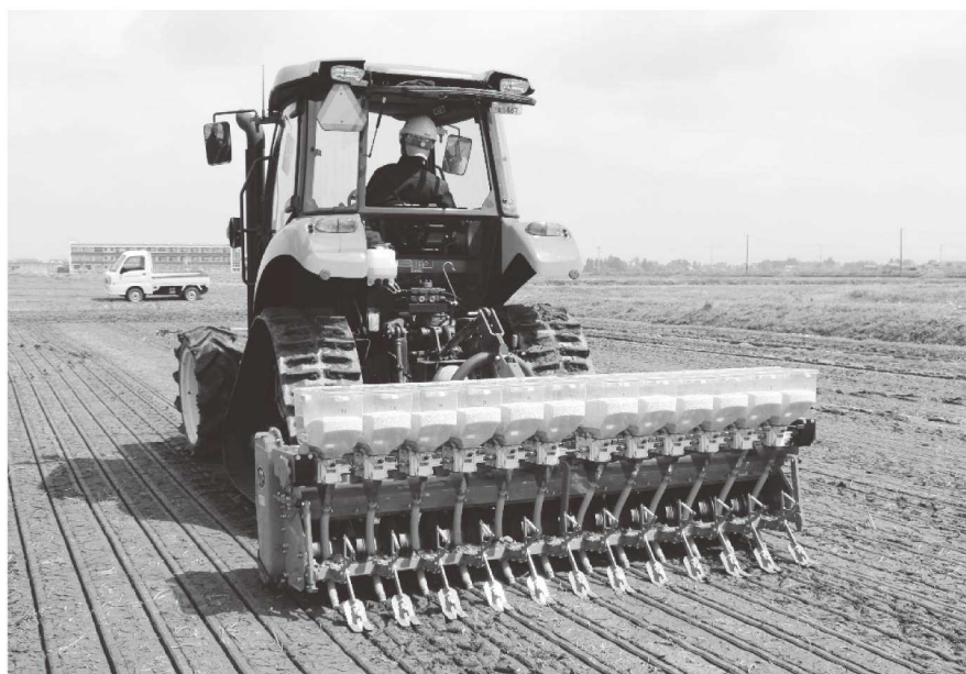
▲稲作コスト削減の切り札と水資源の有効利用のV溝乾田直播
