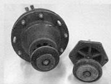
砂利が噛んだまま給水栓を開めたことによりくぼみができた給水栓の弁体 (左：自動給水栓 右：手動給水栓)
